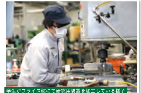
学生がフライス盤にて研究用装置を加工している様子
