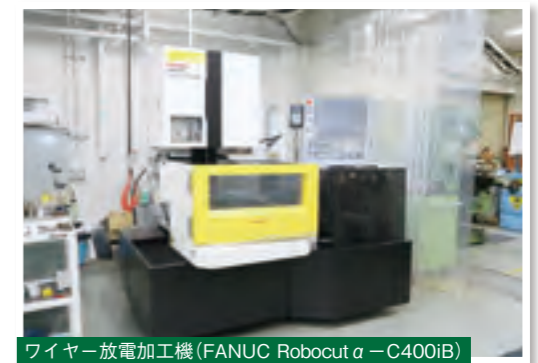
ワイヤー放電加工機(FANUC Robocut alpha-C400iB)
