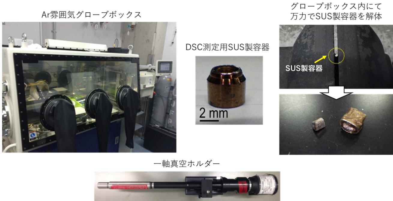
図 1. 電解液系リチウム電池用材料を TEM 観察するための実験環境
