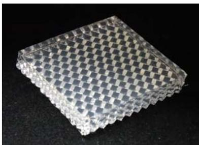
図1 試作した寒天製の食べられる再帰性反射材の写真
