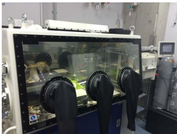
図2. 硫化物系電解質を空気にさらさずにTEM観察するための実験環境 左：グローブボックス 右：真空TEMホルダー
