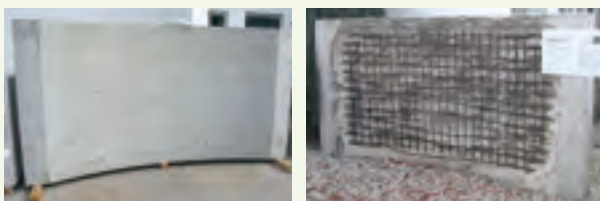
コンクリートの加熱実験 左)加熱前 右)加熱後:爆裂の発生
