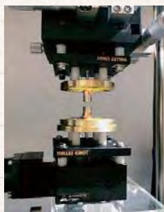
空中に小さな塵を1つ浮かせる装置
